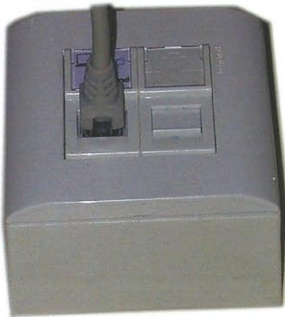
Figura 7.14. BAT para cables de pares trenzados.
