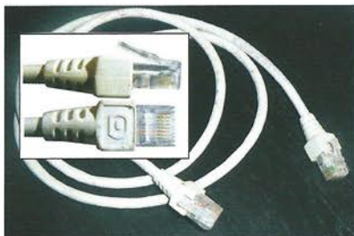
Figura 7.29. Latiguillo de interconexión.
