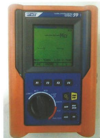
Figura 7.64. Equipo de medida con función de medidor de aislamiento.
