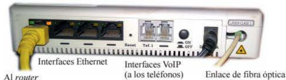
b) Ejemplo de unidad de terminación de red óptica (UTO)
