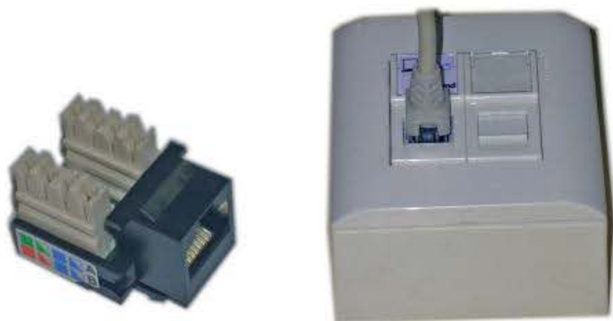
a) Conector RJ-45 hembra. b) BAT de cable de pares trenzados.
