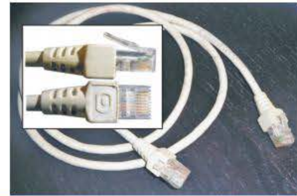
Figura 7.29. Latiguillo de interconexión.
