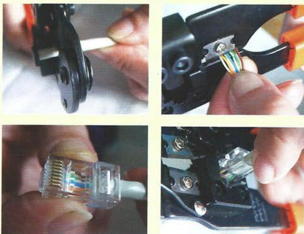
Figura 6.45. Preparación de un conector RJ-45 macho.
