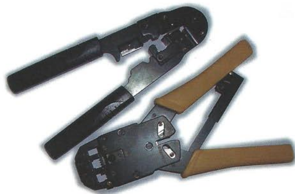
Figura 6.44. Herramientas de presión (crimpadoras).
