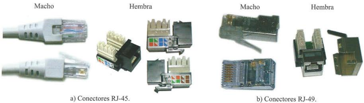
Figura 6.31. Conectores RJ para cable de par trenzado.
