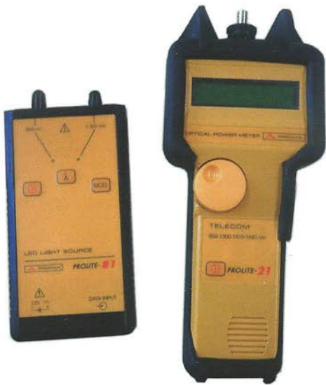
Figura 6.84. Fuente de luz y medidor de potencia.
