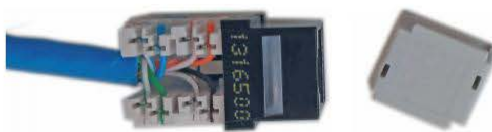
Figura 6.33. Conexión del cableado de par trenzado.
