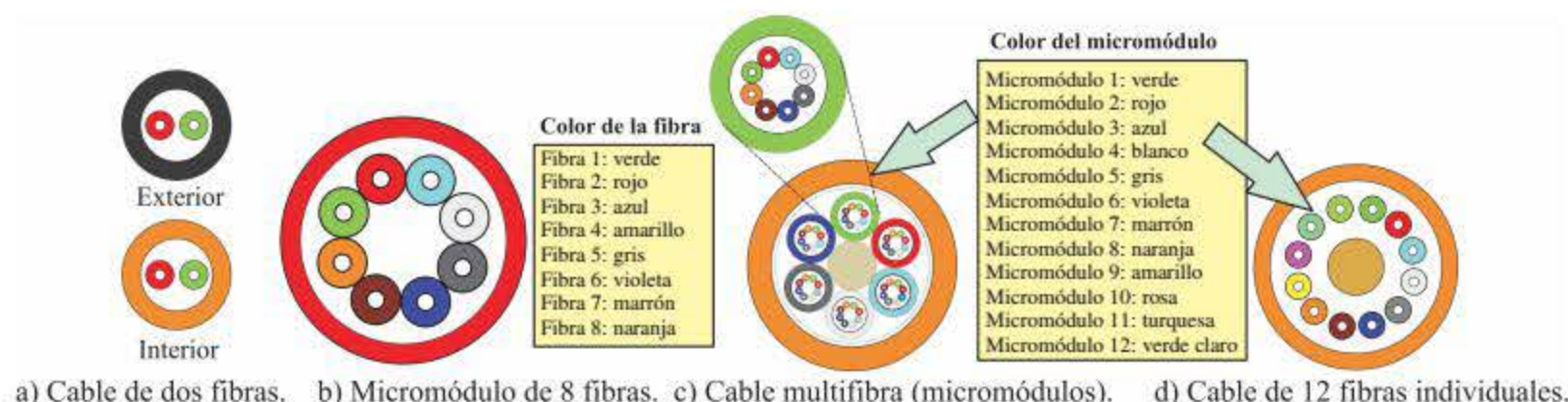
Figura 6.79. Identificación de las fibras ópticas.
