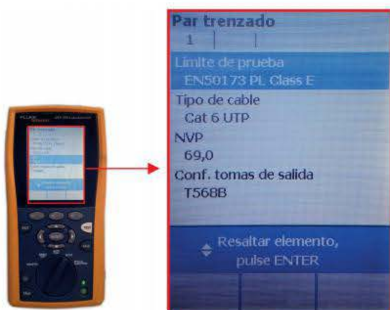
a) Configuración de la prueba.
