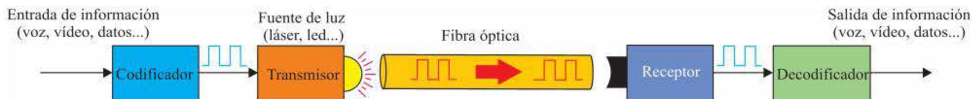
Figura 6.53. Principio de transmisión por fibra óptica.
