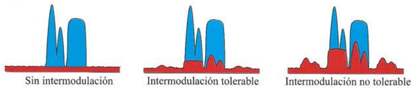
Figura 4.4. Efecto de la intermodulación en canales de TV.
