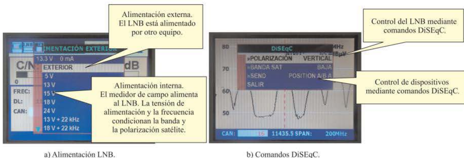
Figura 5.56. Alimentación del LNB a través del medidor de campo.
