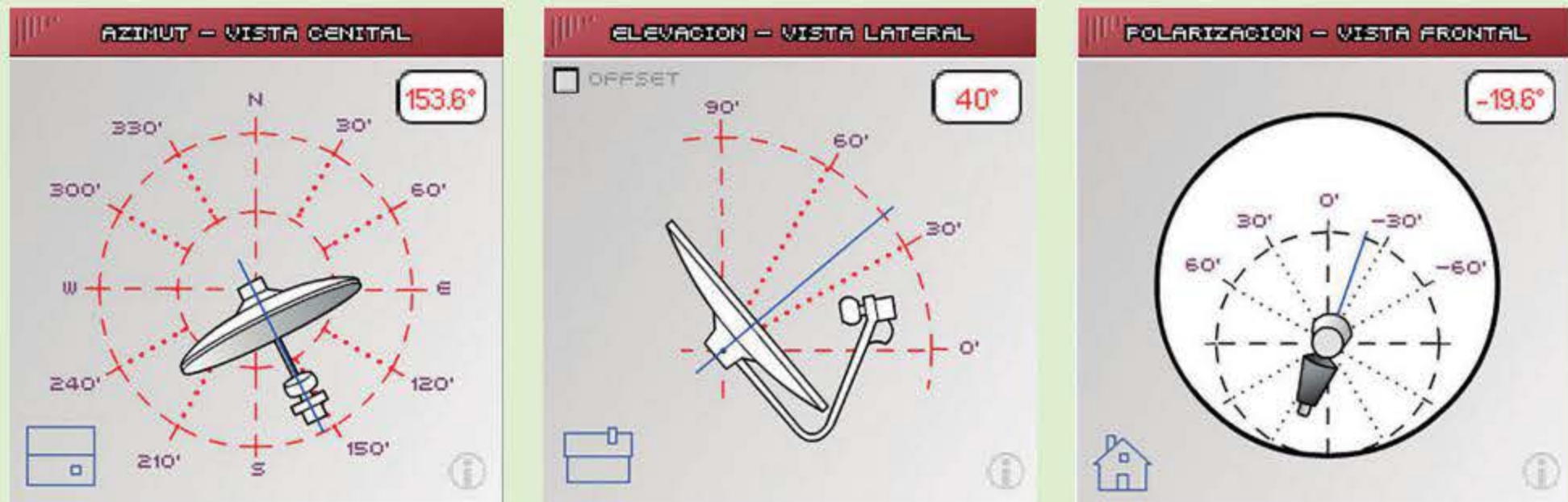
Figura 5.34. Aplicación para la orientación de reflectores parabólicos.
