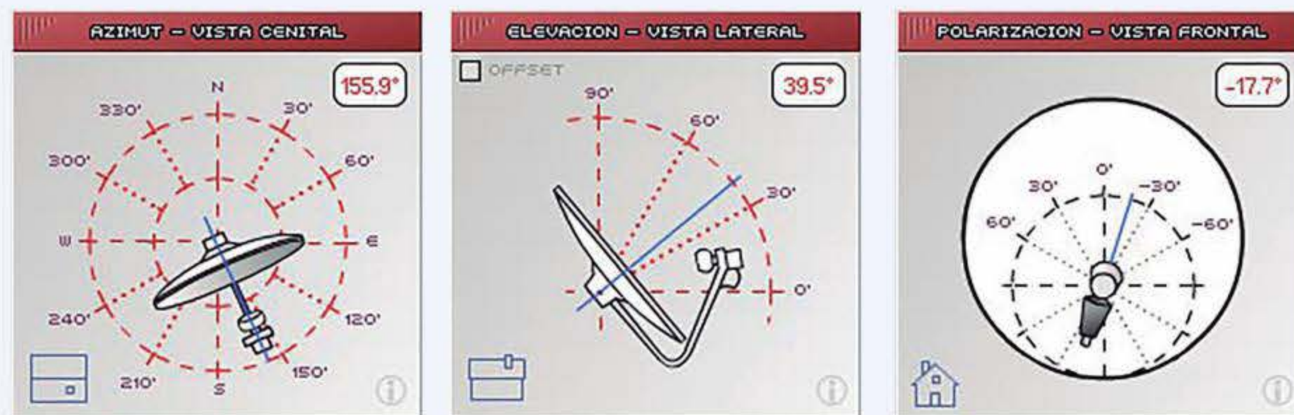
Figura 5.62. Resultado de los parámetros de orientación de un reflector satélite.
