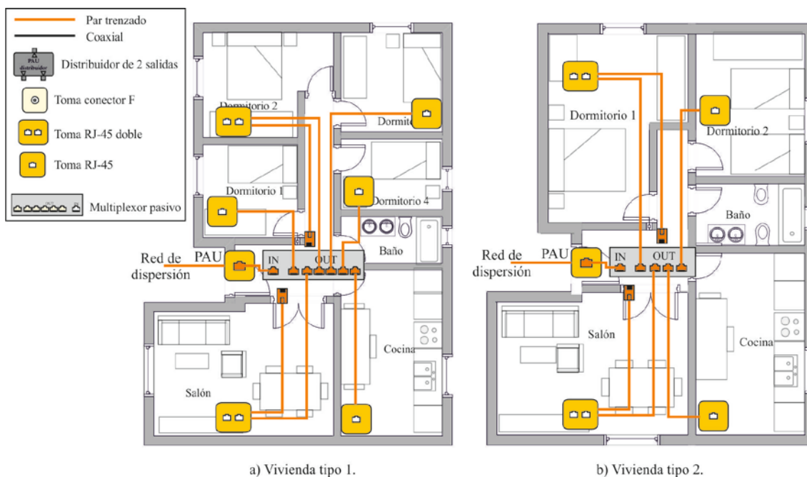
Red interior de cable de pares trenzados
