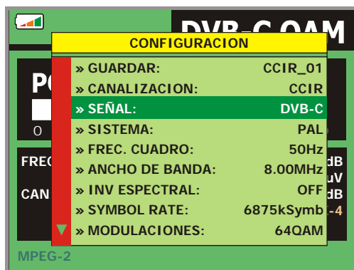
Figura 18.- Pantalla de configuración de medida de señales moduladas en QAM.
