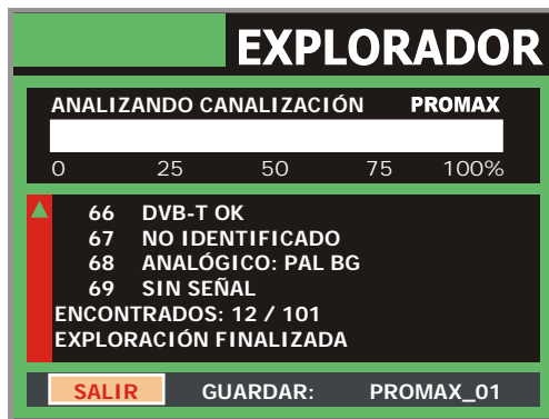
Figura 17.- Pantalla de exploración del espectro. EXPLORER.
