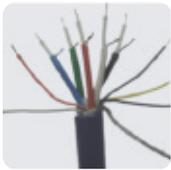
**3.** Trence el blindaje de cada uno de los cables de señal de manera que queden unos 5mm de cable libre y estañe la punta del cable (alternativa: use terminales para cable de 0,34mm).les para cable de 0,34mm).
