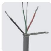
**3.** Retire aproximadamente unos 5mm de la cubierta de los cables y estañe la punta del cable (alternativa: use terminales para cable de 0,34mm).
