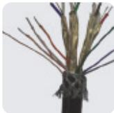
**3.** Elimine unos 10mm de la lámina de blindaje de los cables de señal. Retire aproximadamente 5mm de la camisa de cada uno de los cables y estañe las puntas con un soldador.
