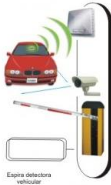
Figura 2-4. Esquema de barrera activada mediante RFID
