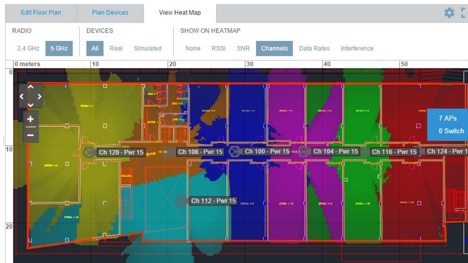
Figura 4-34. Distribución de canales a 5 GHz en la primera planta
