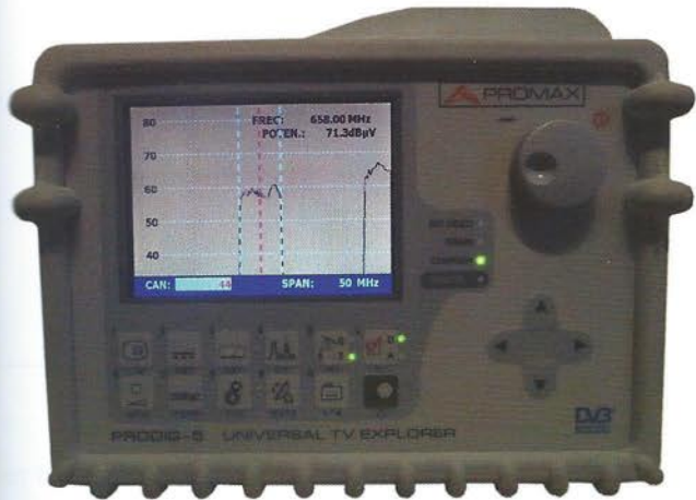
Figura 3.63. Medidor de campo.
