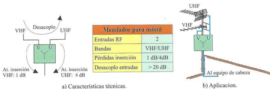
Figura 3.32. Características técnicas de un mezclador para mástil.
